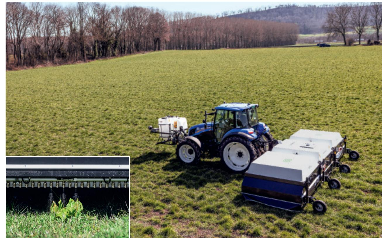
Das hochpräzise Sprühgerät ARA von ecoRobotix versprüht Herbizide nicht grossflächig wie der Bauer auf seinem Traktor, sondern quasi mit der Pipette. 5G soll es erlauben, Daten zu sammeln, zu verarbeiten und seine Rückschlüsse dem Landwirt mitzuteilen.
