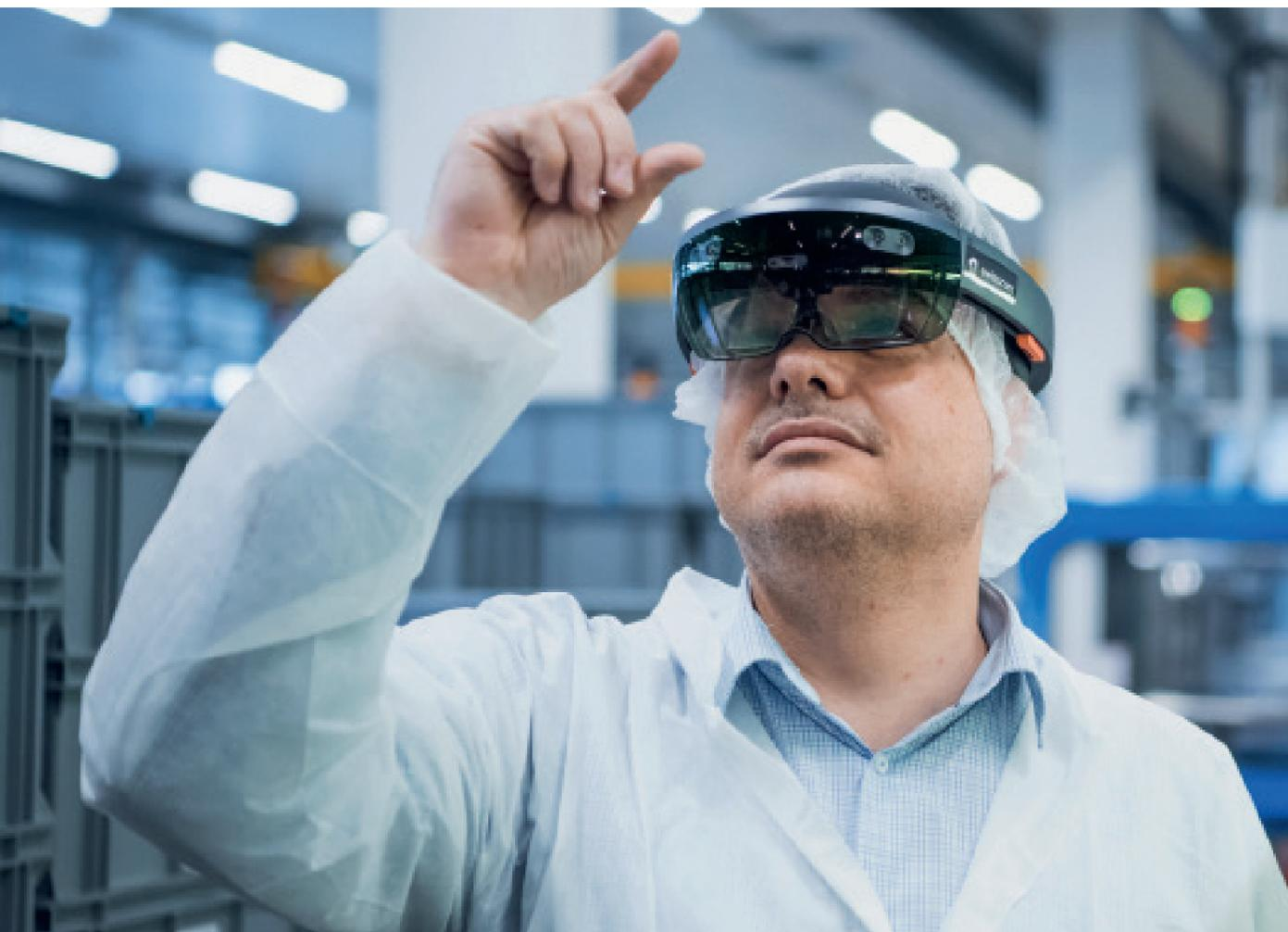
Mit der sogenannten Augmented-Reality-Brille kann die physische Umgebung mit digitalen Inhalten angereichert werden, beispielsweise mit digitalen Bedienmenüs zur Steuerung, Prüfung oder Messung von Produkten. Darum sieht es im gezeigten Beispiel von Ypsomed auch so aus, als klicke der Brillenträger «in der Luft». Bild: Swisscom
