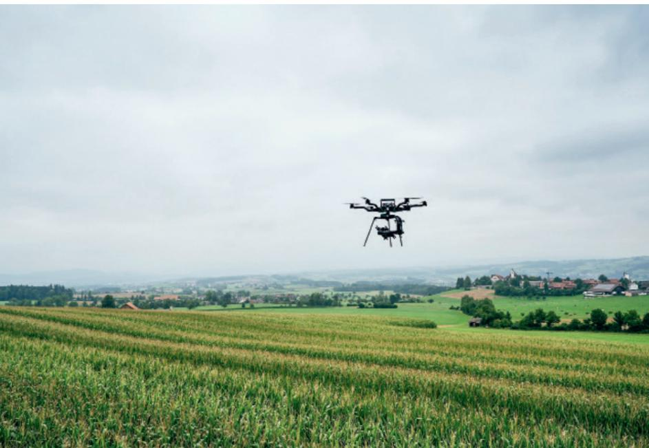
Bereits heute kreisen mit Sensoren bestückte Drohnen über Äckern, um etwa die Vegetation der Pflanzen zu messen. Daraus lässt sich die Menge der Biomasse herleiten, was wiederum der Berechnung des Stickstoffanteils dient. Bild: Swisscom
